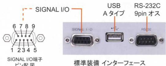
フロントパネルには、「START」、「STOP」ボタン外部制御用のリモート端子を装備。リアパネルには、SIGNAL I/O、USB、RS-232Cを標準装備。SIGNAL I/Oポートは、試験スタート・ストップ制御の他にインターロック機能を装備、PLCからの制御が可能です。インターロック機能は、担当者以外の作業者が試験器を操作を防ぐキーとして使用できます。センサースイッチや試験治具の安全扉に接続し、外部セキュリティ機能としてご使用できます。RS-232CとUSBは標準装備、GPIBはオプション対応です。PCに試験データと試験結果を送ることが可能です。
